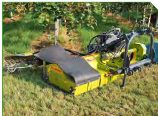
Fig. 3 Trinciaerba con decespugliatore laterale
