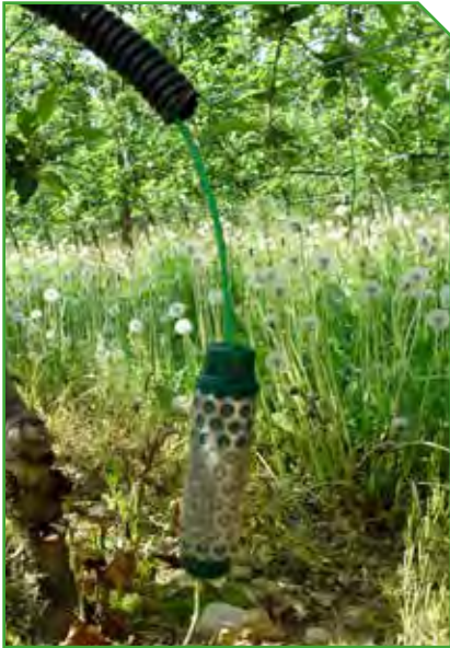
Fig. 5 Tensiometri elettronici (Watermark)
