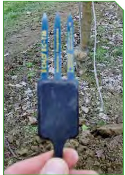
Fig. 6 Sonde di umidità
