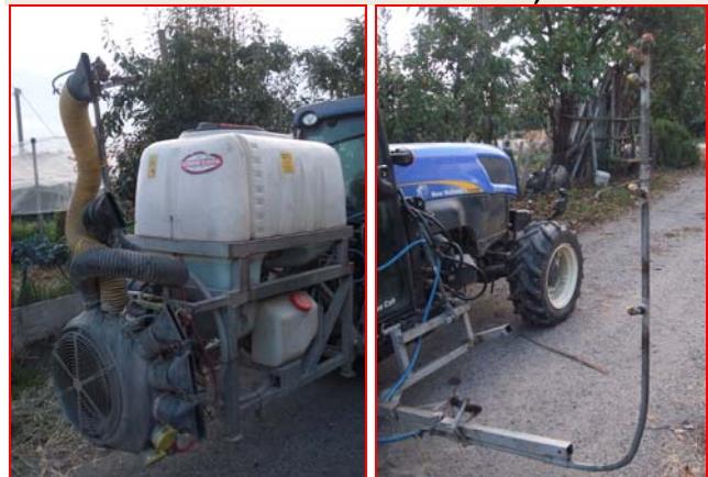
Fig 4: esempio di modifiche apportate al mezzo di distribuzione per ottimizzare la bagnatura fogliare (modifica realizzata dall'Università di Torino - DEIAFA)
