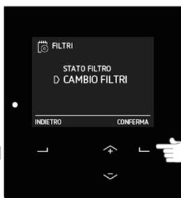
2. Eseguire l'intervento in sicurezza: attivare la modalità di sostituzione filtri (o scollegare la macchina – fare riferimento al Manuale Utente!).
