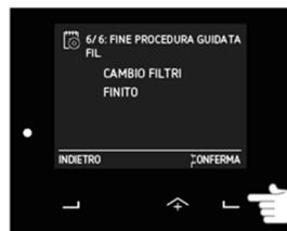
6. Uscire dalla modalità "cambio filtri" (o ricollegare la macchina) azzerare l'allarme filtro sporco e riprendere il funzionamento abituale.
