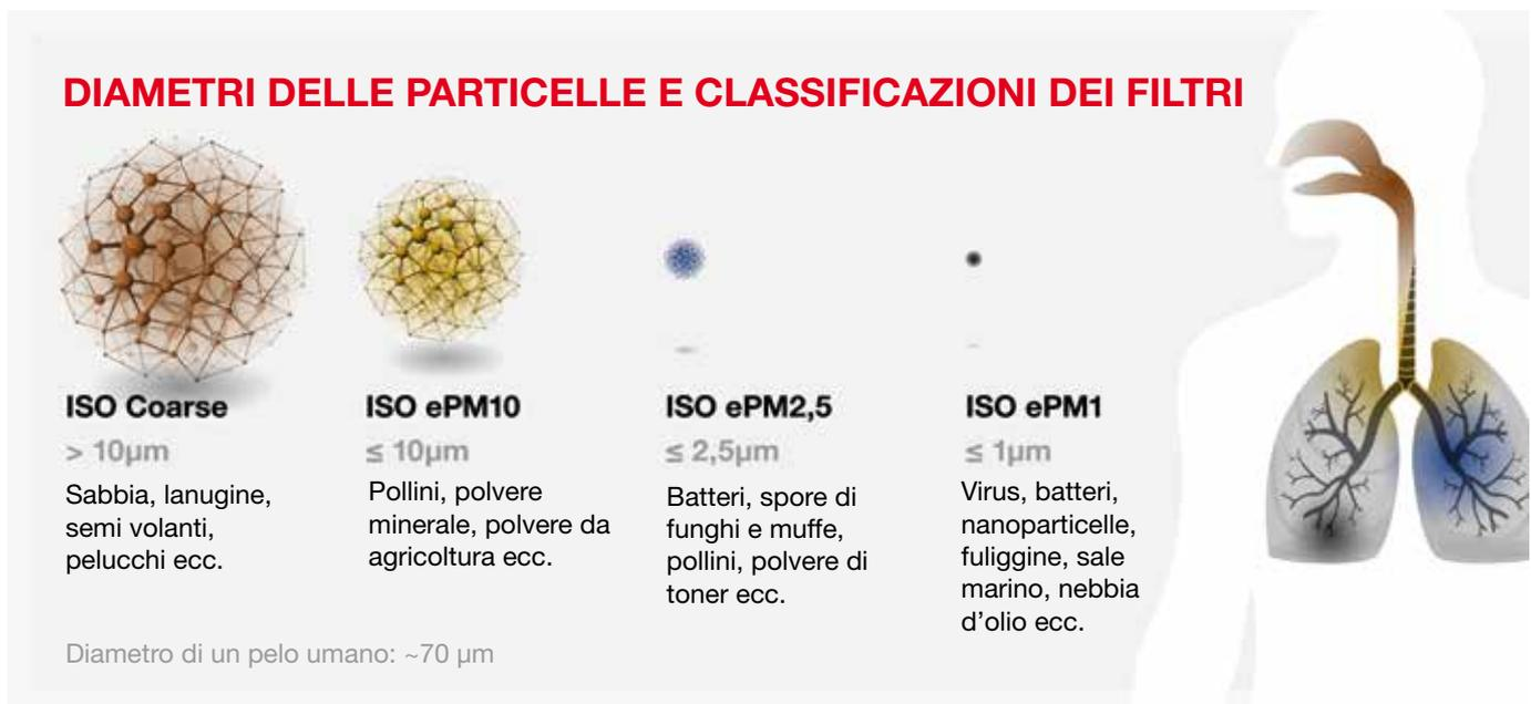
Diametri delle particelle e classificazione dei filtri in base alla nuova norma ISO 16890 sui filtri dell'aria
